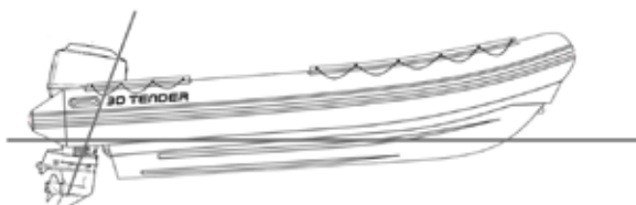
L'avant du bateau déjaugé, trop de trim positif
